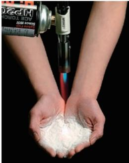
熱反射・熱放射に優れ、手にのせたセラミック粒子を1300℃のバーナーであぶっても熱さは感じない
